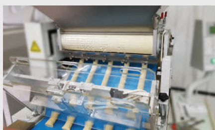
Механизм гильотинной резки МРСП
