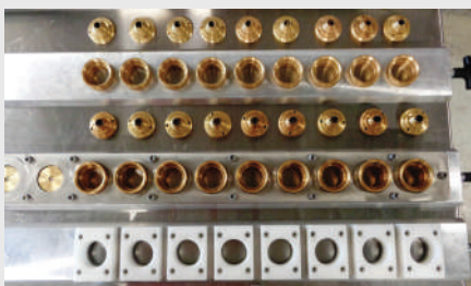
Насадки и фильеры для отсадочно-дозировочной машины
