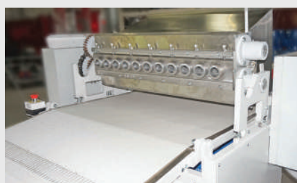
Ленточный транспортер подкатной формовочной машины
