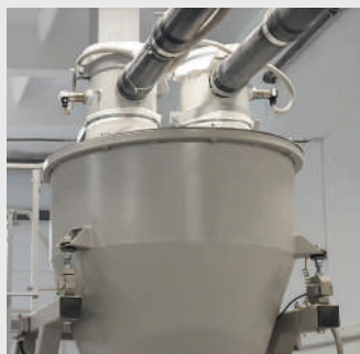
Загрузочные воронки линии БХМ на дозаторе муки
