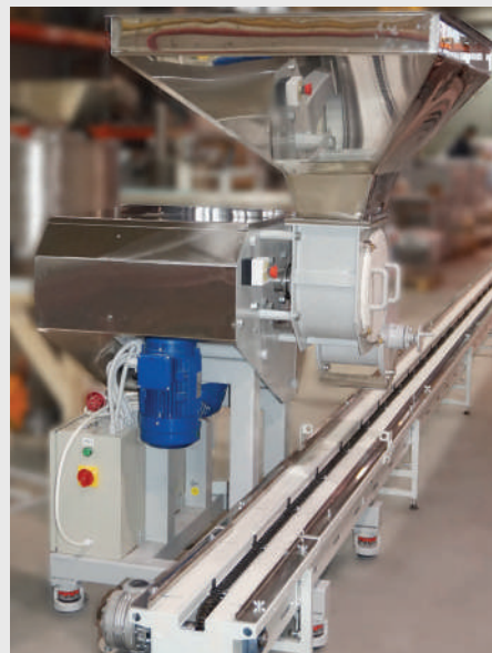
Тестоделитель лопастной с цепным конвейером
