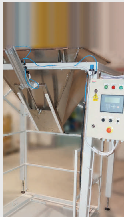
Воронка дозирования опары в подкатную дежу с пультом управления на базе КВУ
