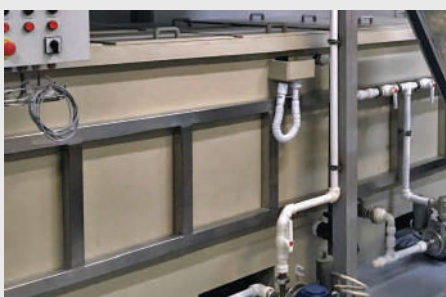
Солерастворитель пластиковый СРП-3 в каркасе из нержавеющей стали
