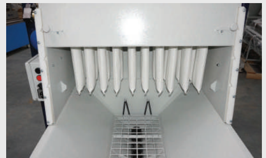
Система аспирации установки просеивания муки УГМ
