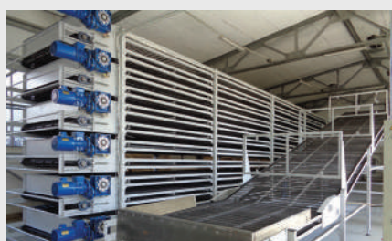
Многоярусный конвейер сушки пряника после глазирования
