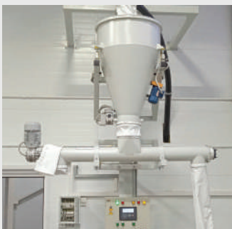
Дозатор муки с реверсивным раздатчиком
