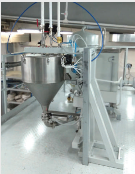
Дозатор жидких компонентов с креплением на раме
