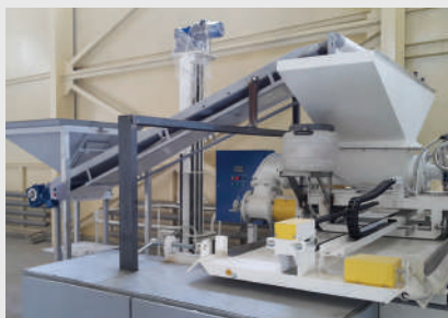
Подача теста в делитель-укладчик через ленточный транспортер
