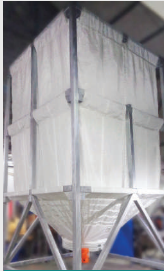
Бункер тканевый на 18м 3 с вибродвищем
