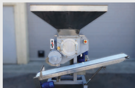
Тестоделитель ТДЛ-2 с ленточным транспортером
