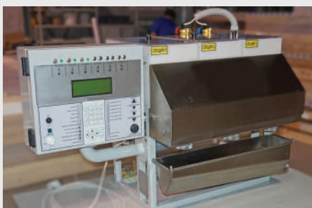
Станция непрерывного дозирования на 3 компонента СДМ-8
