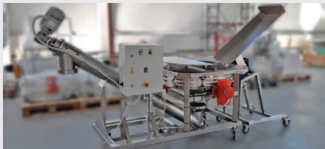
Передвижной комплекс для просеивания сыпучих компонентов
