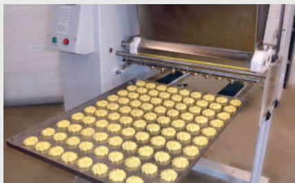
Напольная отсадочно-дозировочная машина ОДМ-1 с функцией вращения насадок
