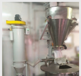
Крышка точки дозирования, дозатор муки и установка пневмоаспирации
