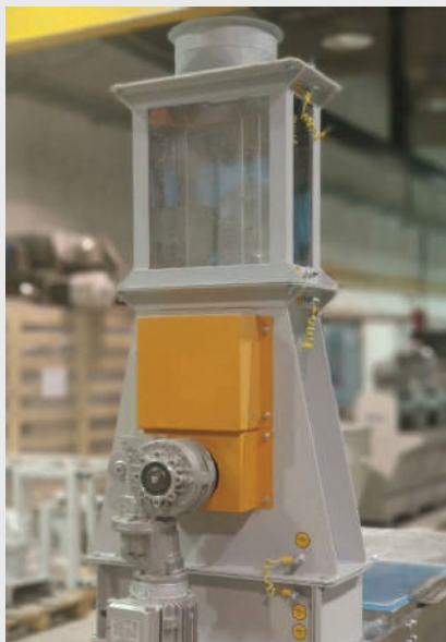
Роторный дозатор муки на тестомесильной машине непрерывного действия
