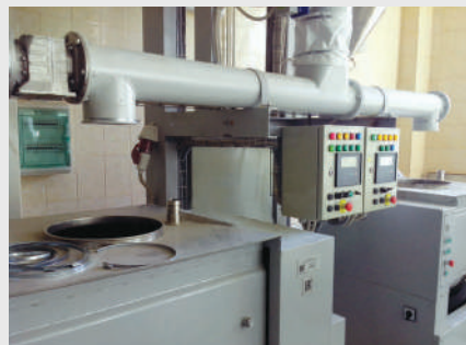
Пульты управления дозатором муки с реверсивным раздатчиком на базе КВУ
