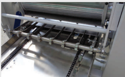
Механизм струнной резки формовочной машины
