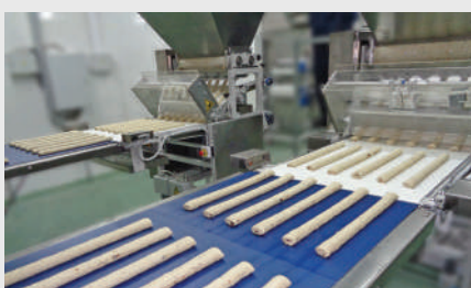
Машина для резки сухарных плит с транспортером укладки
