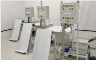
Мешкопрокидыватели с электромеханическим приводом
