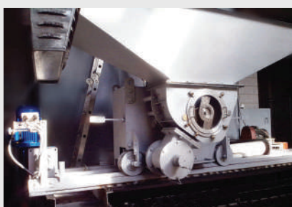
Тестоделитель-укладчик с лопастным нагнетанием Ш33-ХД4
