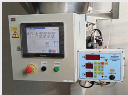
Панель управления вакуумным дозатором на 4 сорта муки на базе ПЛК
