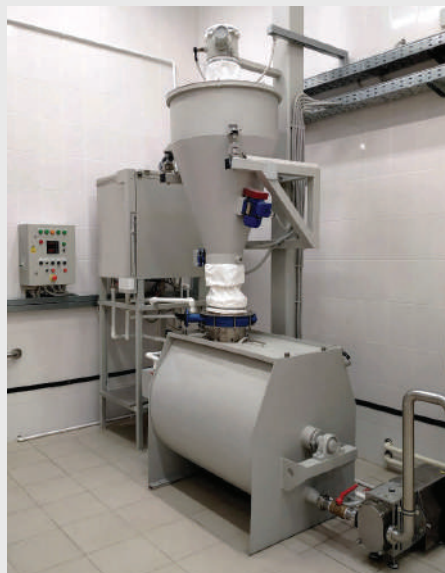
Участок приготовления заварки с ХЗМ и дозатором воды
