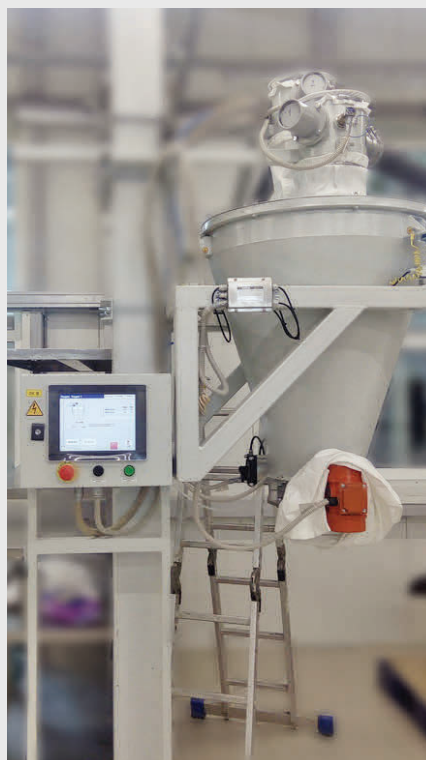
Панель управления дозатором муки на базе ПЛК
