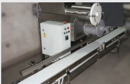
Тестоделитель Кузбасс с ленточным транспортером и датчиком наличия форм
