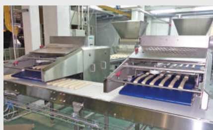
Укладка тестовых заготовок для сухаря на поперечный транспортер
