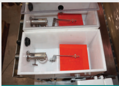
Баки многокомпонентной станции дозирования СДМ-8
